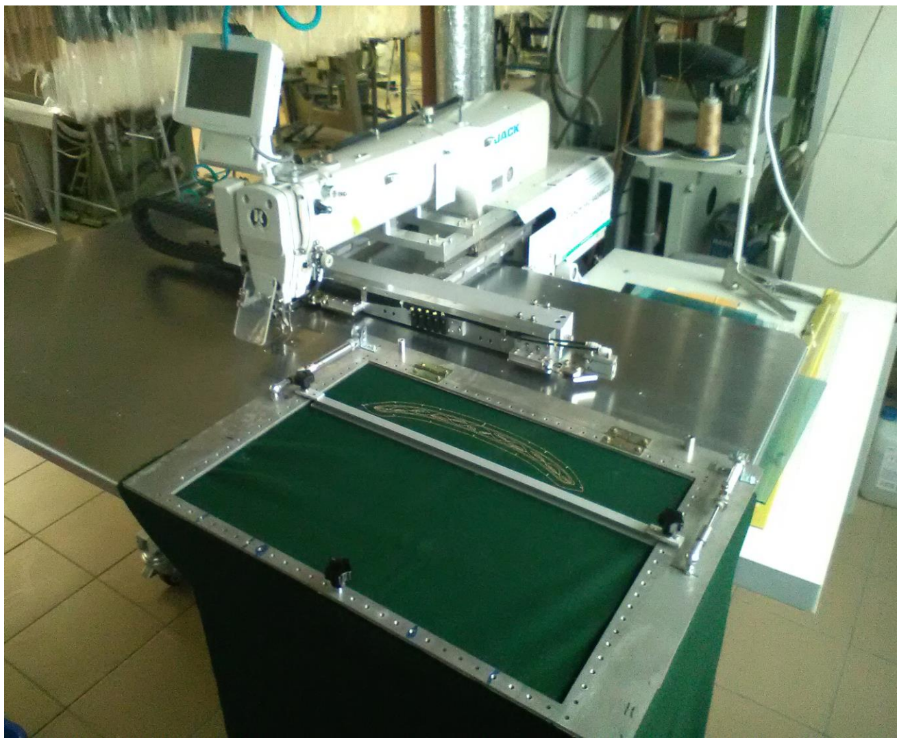
Wykonane narzędzie na automacie szwalniczym.
