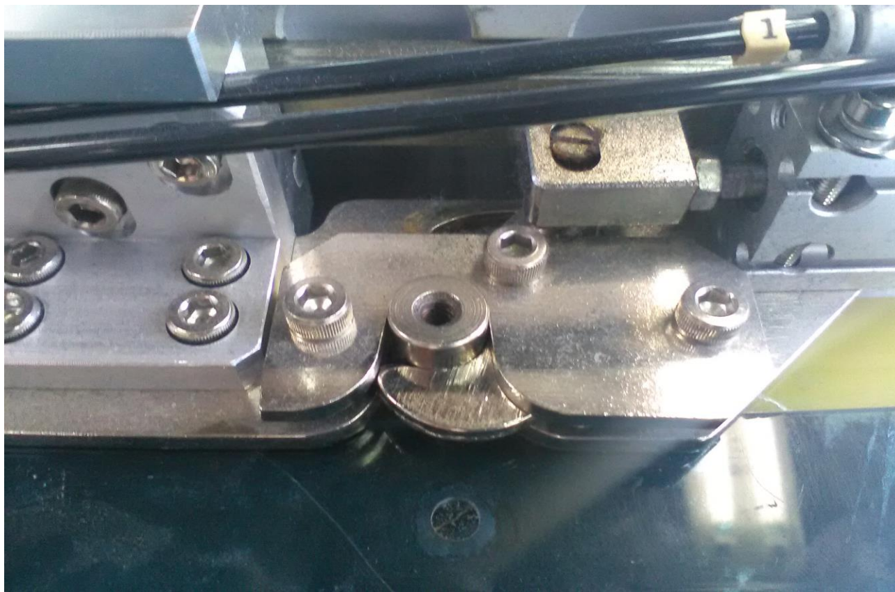
Zablokowany trzpień narzędzia w gnieździe automatu.
