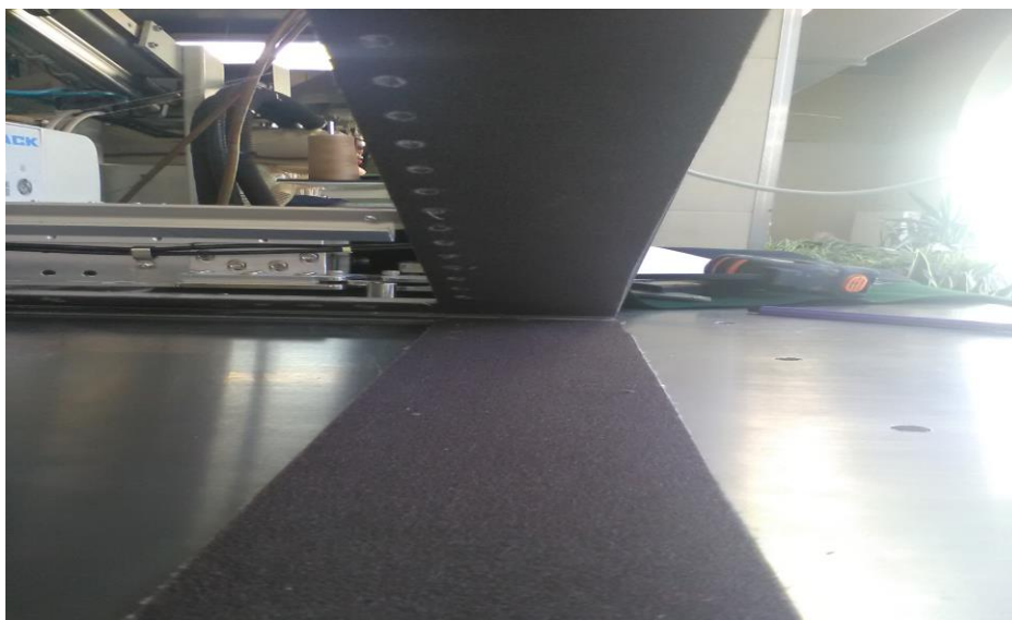
Części narzędzia od strony tkaniny oklejona papierem ściernym.
