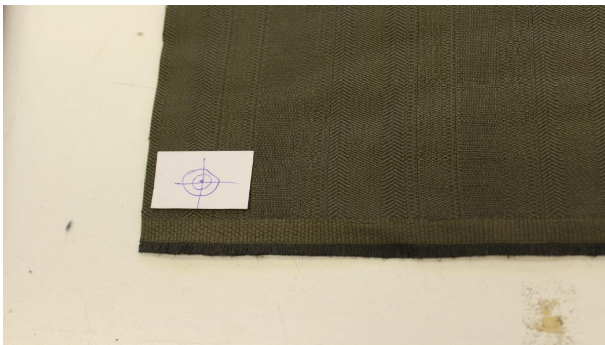
Miejsce pogrubienia tkaniny związane z umieszczeniem etykiet.
