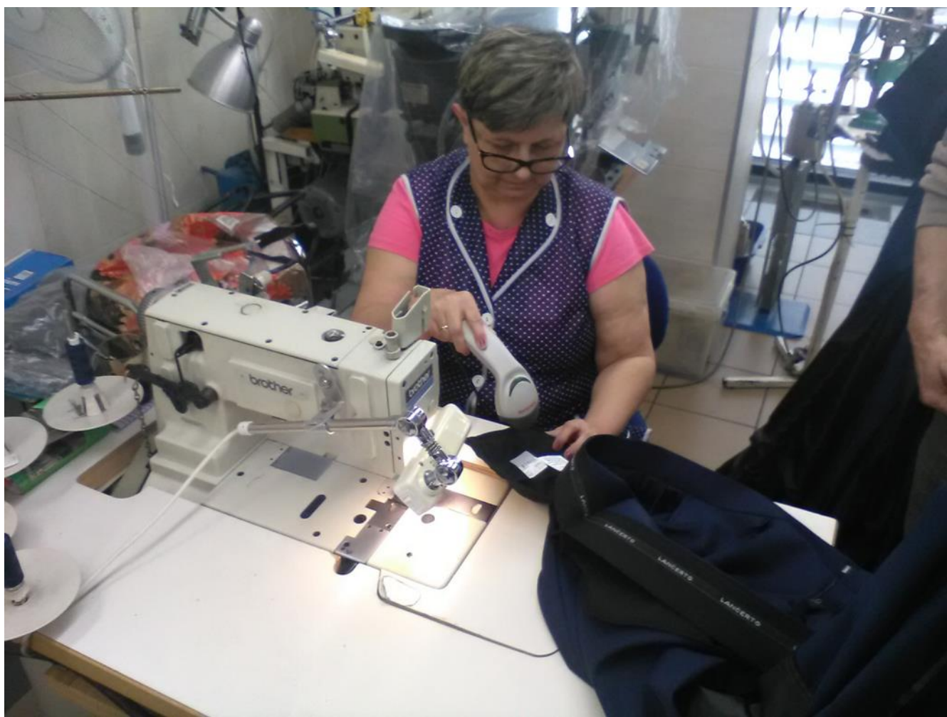
Skanowanie kodu kreskowego przez szwaczkę.
