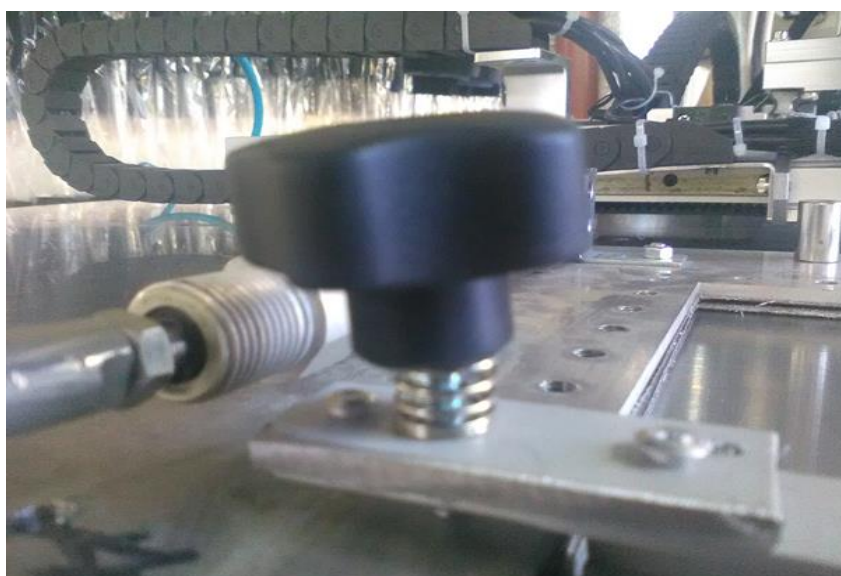
Sprężyny dociskające poprzeczkę do tkaniny
